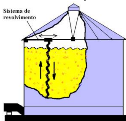
Figura 9 – Silo com equipamento para revolvimento do produto
