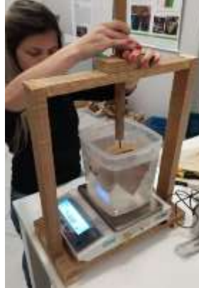
Figura 3 – Determinação do volume pelo método da balança hidrostática.
