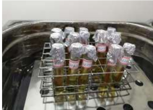
Figura 5 – Tubos de ensaio contendo os fragmentos de madeira e reagentes em banho maria.
