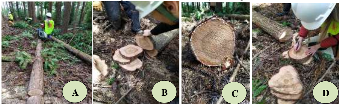
Figura 2 – Coleta do material a campo. (A) Derrubada, (B) Discos coletados, (C) Exsudação de extrativos na transição madeira-casca e (D) Marcação das amostras.
