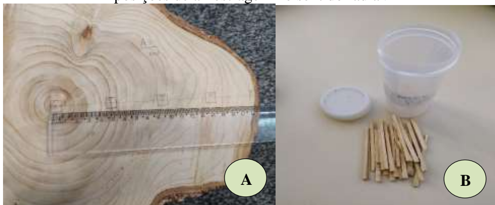
Figura 4 – (A) Disco com bagueta e posições demarcadas e (B) Fragmentos de madeira das posições de amostragem no sentido radial.
