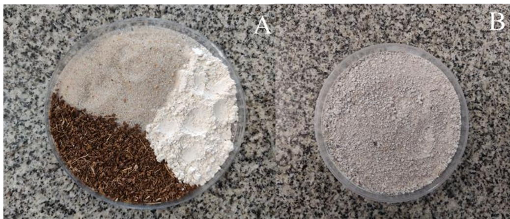
Figura 1 - A: Materiais que compõem o Solo Artificial Tropical (SAT).; B: SAT pronto para uso.
