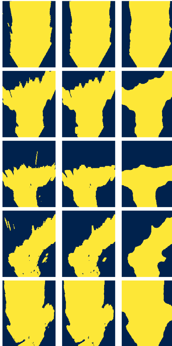
Figura 18 – Exemplos da aplicação das operações de morfologia matemática de abertura e fechamento para occupancy grids. Na primeira coluna temos o OG sem modificação. Na segunda coluna podemos ver o OG depois de aplicarmos a operação de abertura. Na terceira coluna podemos ver o resultado de aplicarmos a operação de fechamento no OG da segunda coluna.
