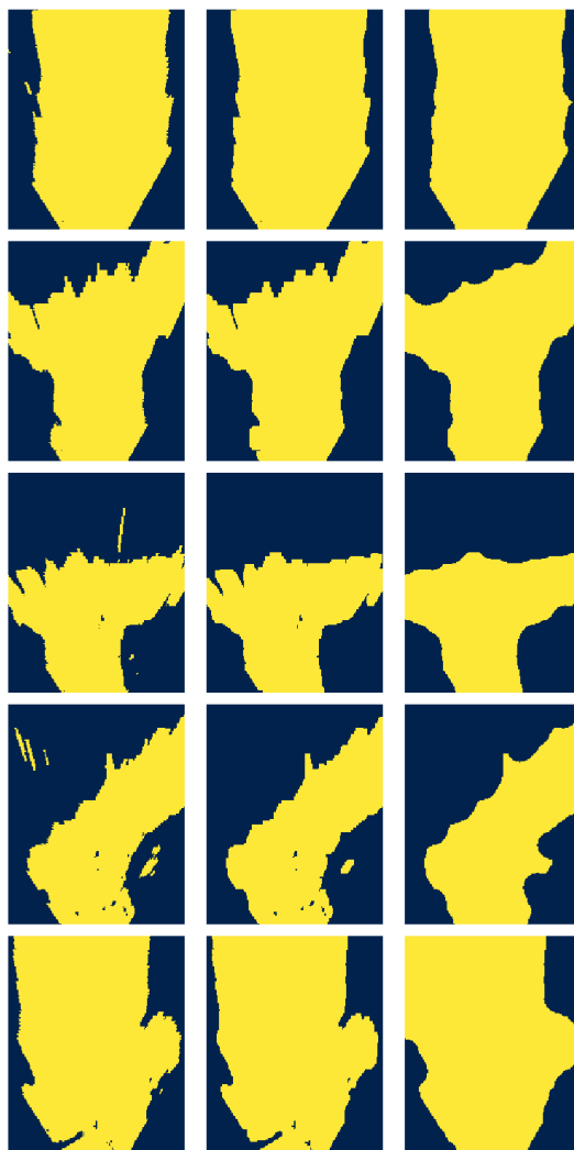
Figura 9. Exemplos da aplicação das operações de morfologia matemática de abertura e fechamento para occupancy grids. Na primeira coluna temos o OG sem modificação. Na segunda coluna podemos ver o OG depois de aplicarmos a operação de abertura. Na terceira coluna podemos ver o resultado de aplicarmos a operação de fechamento no OG da segunda coluna.
