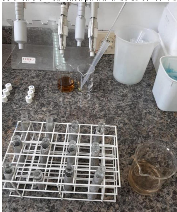
Figura 8: Realização do ensaio em bancada para análise da concentração de polissacarídeos
