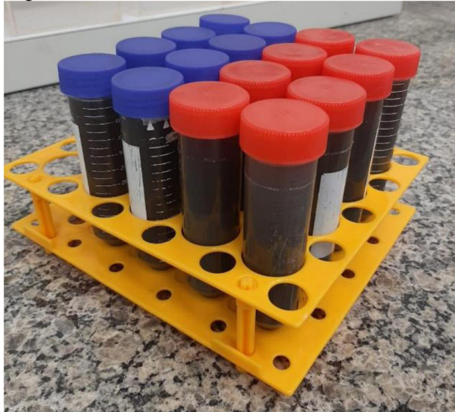
Figura 7: EPS extraído e armazenado em tubos falcon
