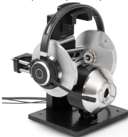
Figura 1 - Estrutura do dispositivo GRAS 45CC Headphone Test Fixture desenvolvido pela GRAS Sound and Vibration. O headset é acoplado à cabeça mecânica para a realização dos ensaios.
