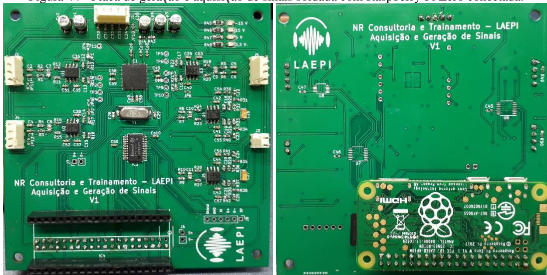
Figura 44 - Placa de geração e aquisição de sinais soldada com Raspberry Pi Zero conectada.
