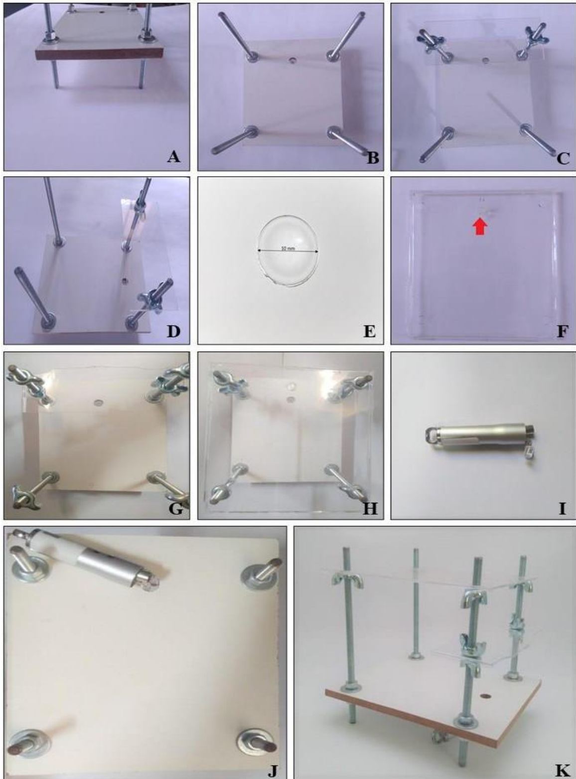
Figura 3 – Foto-documentação dos procedimentos de montagem do microscópio artesanal simplificado. A-B: Etapa 1. C-D: Etapa 2. E-G: Etapa 3. H: Etapa 4. I-J: etapa 5. K: Microscópio simplificado completamente montado.
