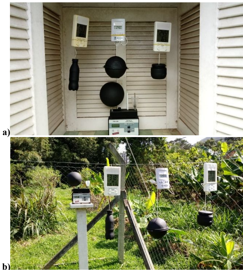
Figura 2 - Instalação no ambiente interno a) e no ambiente externo b) do termômetro de globo negro padrão TGD-200 e dos três termômetros com materiais alternativos.
