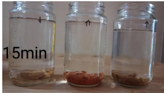
Figura 12: Teste de resistência para escolha da argila
