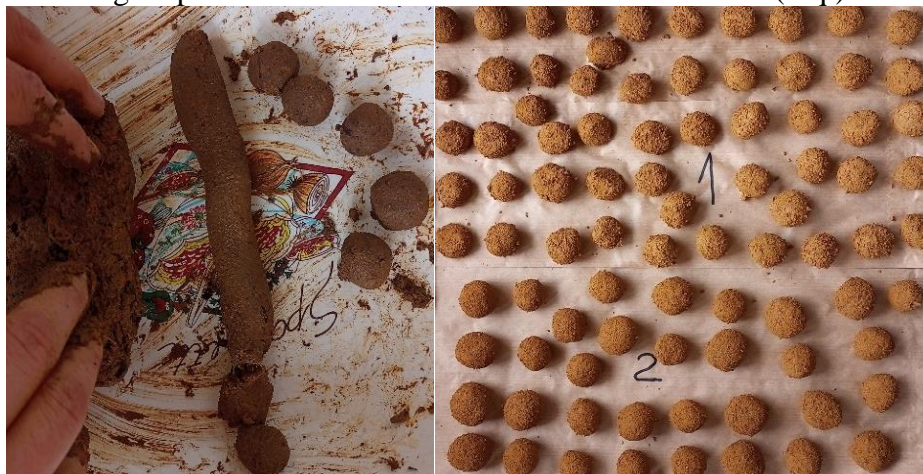
Figura 15: modelagem pelo método manual com a massa mais úmida (esq.) e secagem (dir.)
