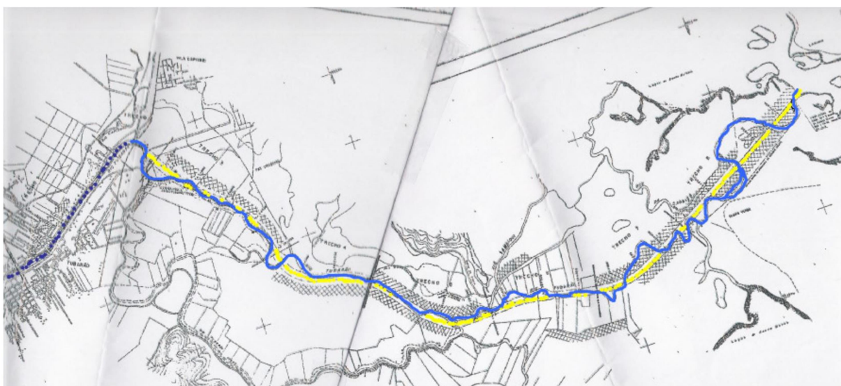
Figura 18 - Projeto do DNOS de retificação e dragagem do Rio Tubarão (DNOS, 1979).
