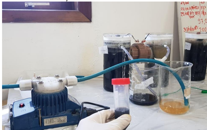
Figura 17 – Realimentação das CCM e coleta de amostra do efluente
