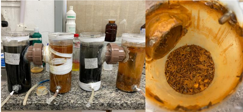
Figura 21 – Aspecto externo e interno da Câmara catódica ao fim do experimento
