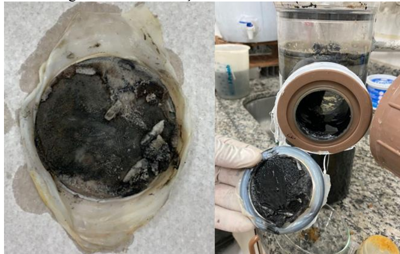
Figura 19 – Incrustação verificada na MTC
