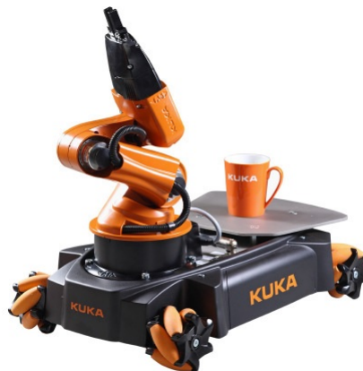
Figura 1 – Kuka youBot - Representação de um manipulador móvel utilizado para pesquisa e educação - retirado de Bischoff et al. (2011).
