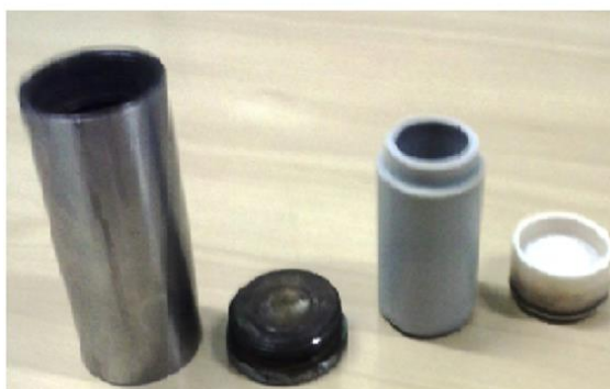
Figura 10 – Reator hidrotermal utilizado na síntese da zeólita Y.
