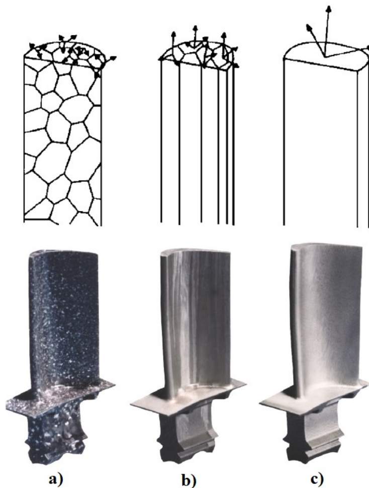
Figura 2.8 - Pás de turbina obtidas por diferentes processos de fundição e respectivas ilustrações esquemáticas de suas microestruturas: a) Fundição convencional resultando em um produto com grãos equiaxiais; b) Solidificação direcional resultando em um produto com grãos alongados e orientados ao longo do comprimento da pá; c) Solidificação monocristalina resultando em um produto formado por um único grão.
