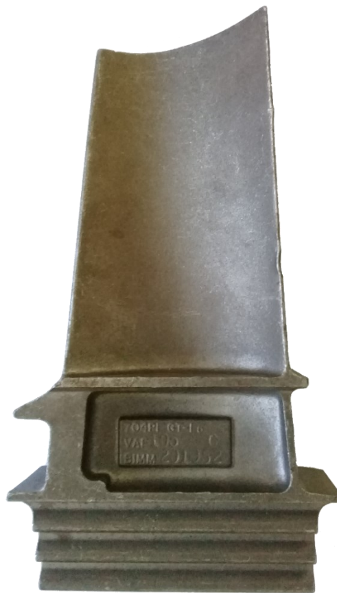
Figura 3.1 - Pá de Turbina da liga GTD-111.
