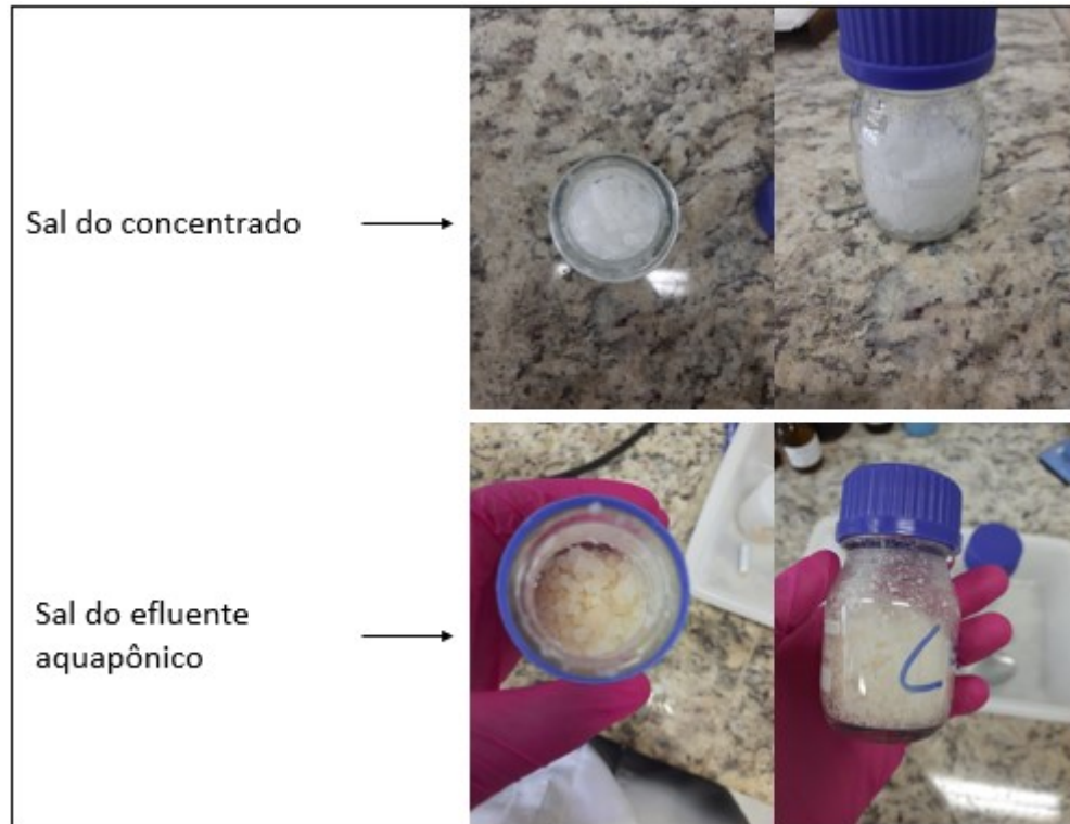
Figura 29 - Sal do concentrado e sal do efluente aquapônico depois de serem coletados para as análises.
