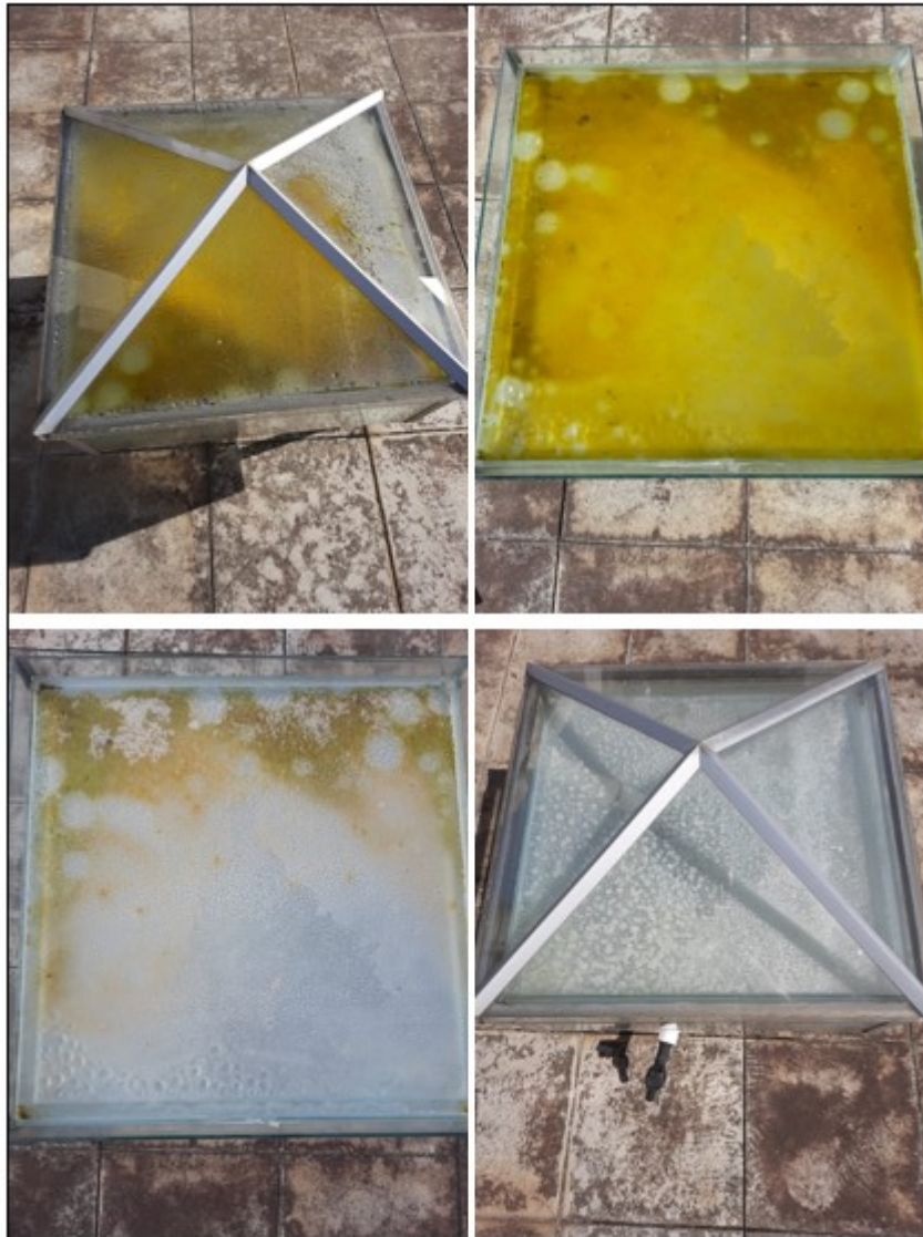
Figura 37 - Destilação solar do efluente do sistema aquapônico.
