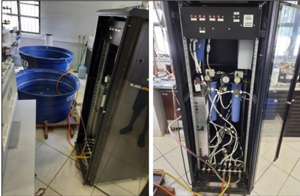
Figura 30 - Dessalinização da água de estudo gerando concentrado.
