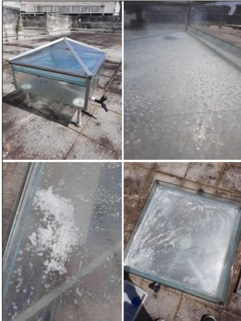
Figura 36 - Destilação solar do concentrado.
