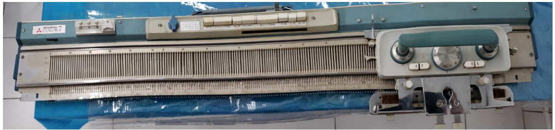
Figura 12 – Tear retilíneo de malha por trama.
