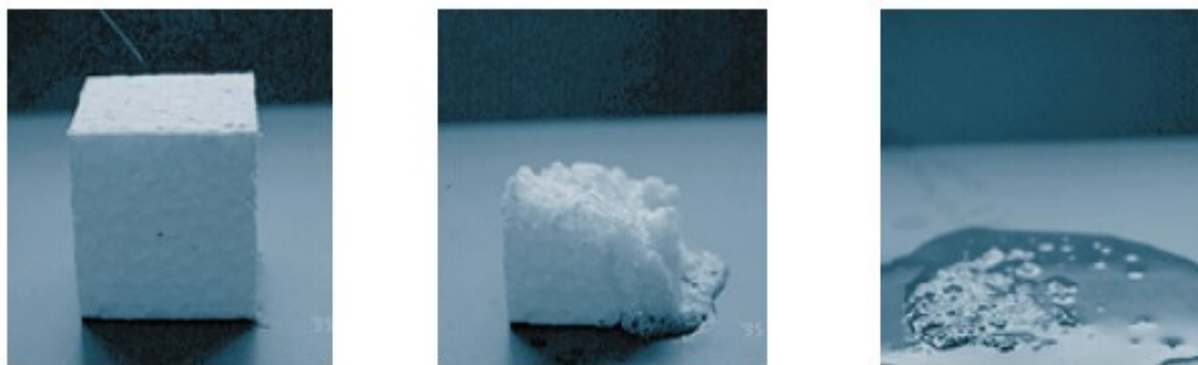
Figura 2.12 - Poliestireno expandido (EPS) dissolvido por d -limoneno nos tempos de 0s, 30s e 180s.
