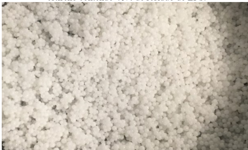
Figura 4.6 - Poliestireno reciclado a partir da polimerização em suspensão de uma solução de estireno contendo 40% de resíduo de EPS.
