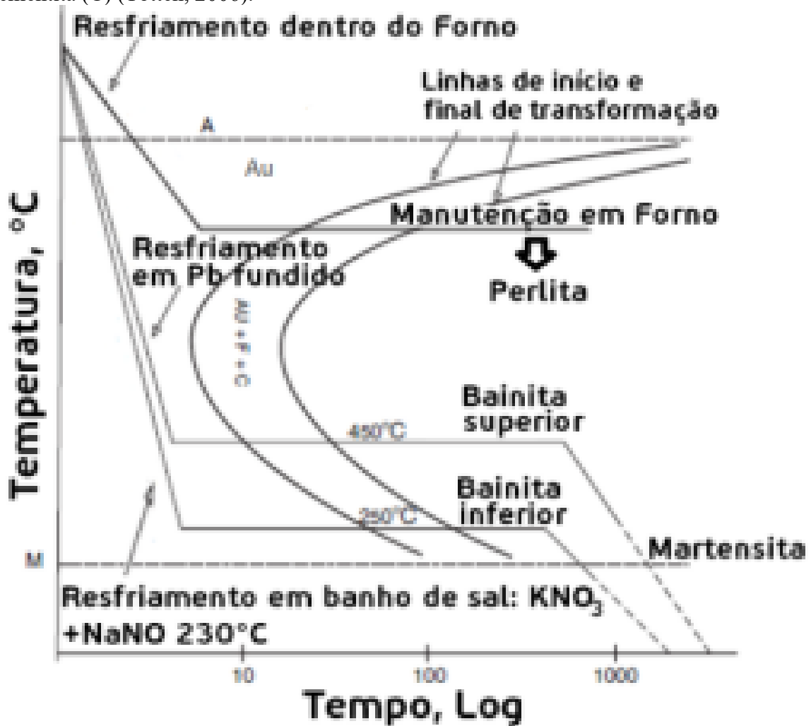
Figura 1 - Diagrama de Transformação-Tempo-Temperatura para um aço com composição eutetóide. Austenita (A), Austenita super-resfriada (Au), Martensita (M), Ferrita (F), Cementita (C) (Totten, 2006).
