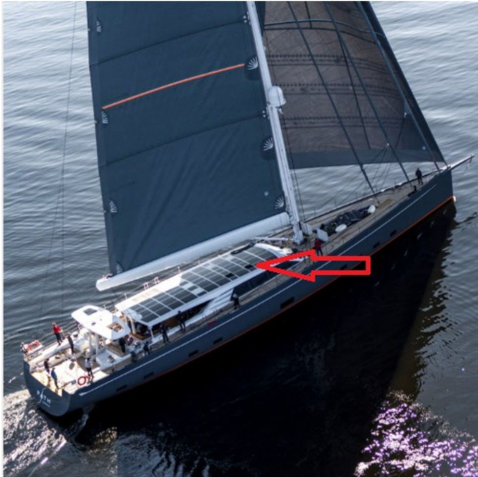
Figura 22 – Filmes fotovoltaicos instalados no coachroof.
