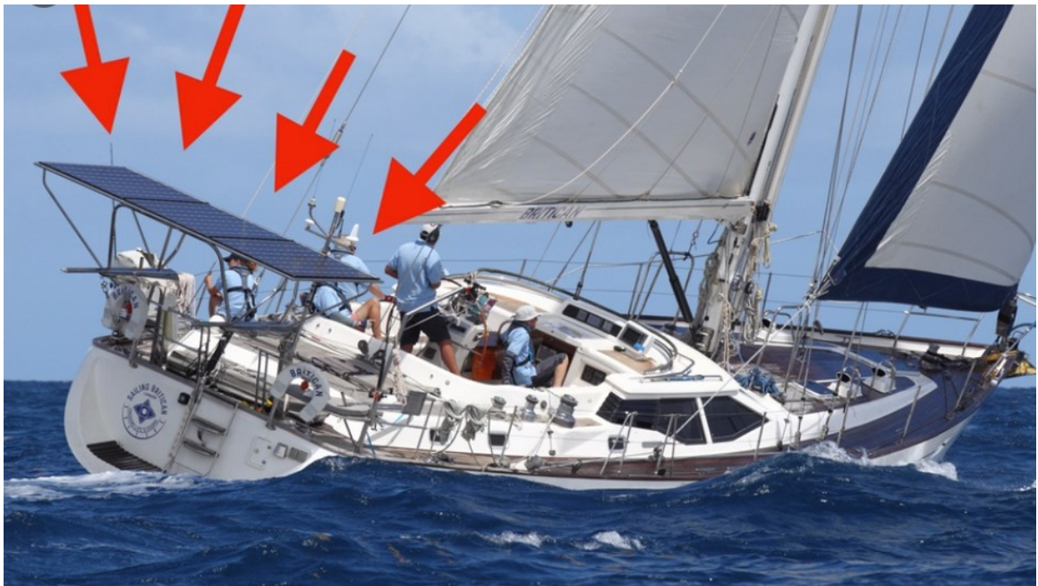
Figura 21 – Painéis fotovoltaicos instalados na região de popa.
