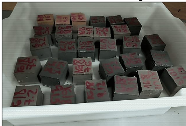
Figura 31 – Aspecto visual dos corpos de prova geopoliméricos após 180 dias de imersão em 1,0 cm de água.
