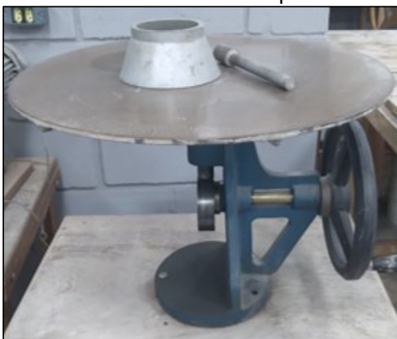
Figura 26 – Ensaio no estado fresco: mesa para índice de consistência.
