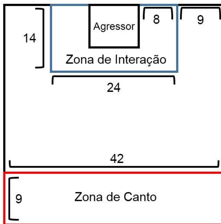
Figura 7. Esquema do aparato para teste de interação social com as representações das zonas de interação (azul), e canto (vermelho), valores em centímetros (Fonte: o Autor).
