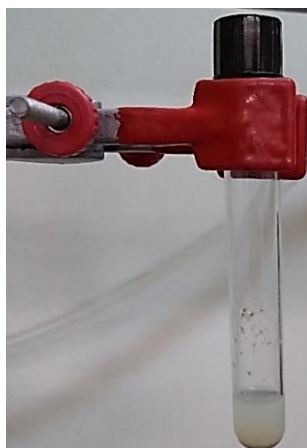
Figura 24. Sistema de condução da reação de Suzuki-Miyaura.
