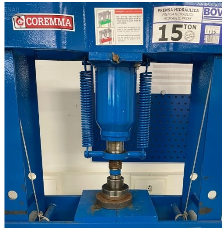
Figura 13 - Moldagem por pressão uniaxial.
