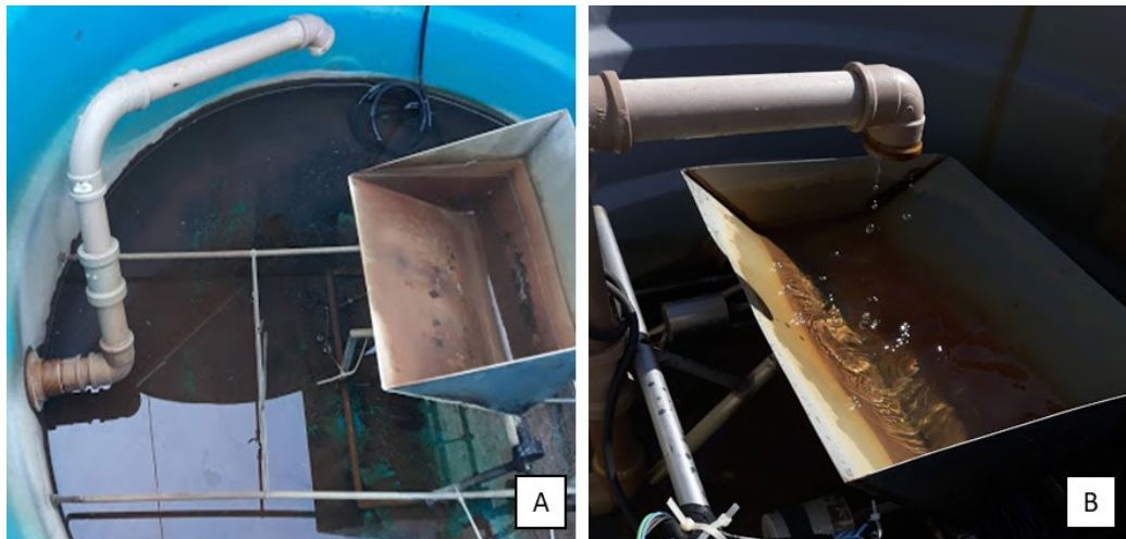
Figura 13 – Sistema de aferição de vazão tipo báscula empregado no reservatório de saída dos wetlands construídos avaliados. Em (A) enchimento da báscula; em (B) esvaziamento da báscula.
