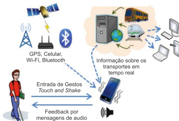
Figura 8 - Arquitetura do sistema Talking Transit
