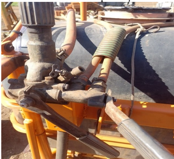
Figura 5 - Pulverizador sem a presença do manômetro.
