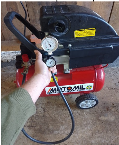
Figura 2- Sistema montado para aferição dos manômetros.
