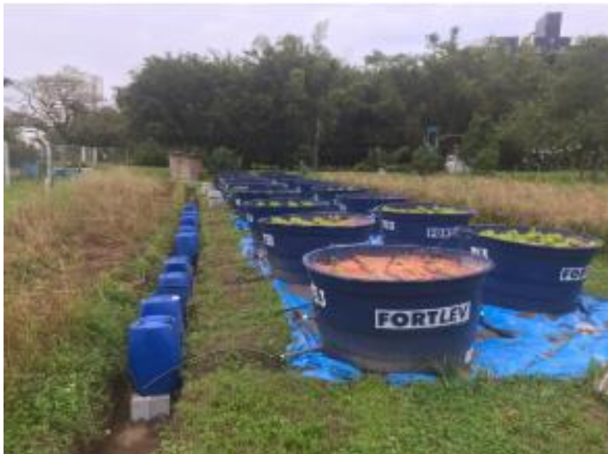
Figura 11 - Vista panorâmica da área experimental com destaque as bombonas de coleta do lixiviado na vala lateral.
