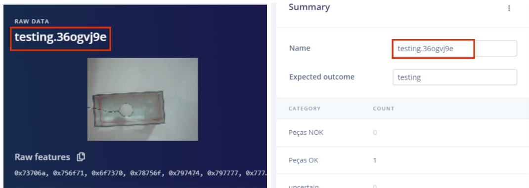
Figura 49 – Inferência de imagens captadas via OV7670 - Peça OK (fonte do autor).
