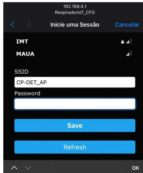
Após selecionar “Save” a rede será salva e essa tela se fechará automaticamente. Depois é necessário esperar alguns segundos para que o dispositivo se conecte adequadamente a rede, então é preciso reiniciá-lo utilizando o interruptor (1), o colocando na posição OFF (indicada como O) por 2 segundos e colocá-lo novamente na posição ON. Com isso concluindo a configuração da rede, que poderá ser verificada visualizando sua rede própria como RespiradorIoT\_AP e não mais como RespiradorIoT\_CFG.
