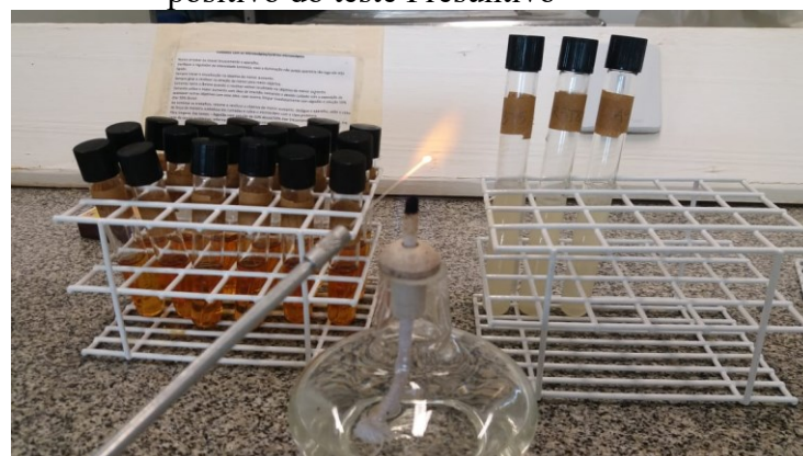
Figura 7 - Inoculação do teste confirmativo com Caldo E.C. através dos tubos com resultado positivo do teste Presuntivo
