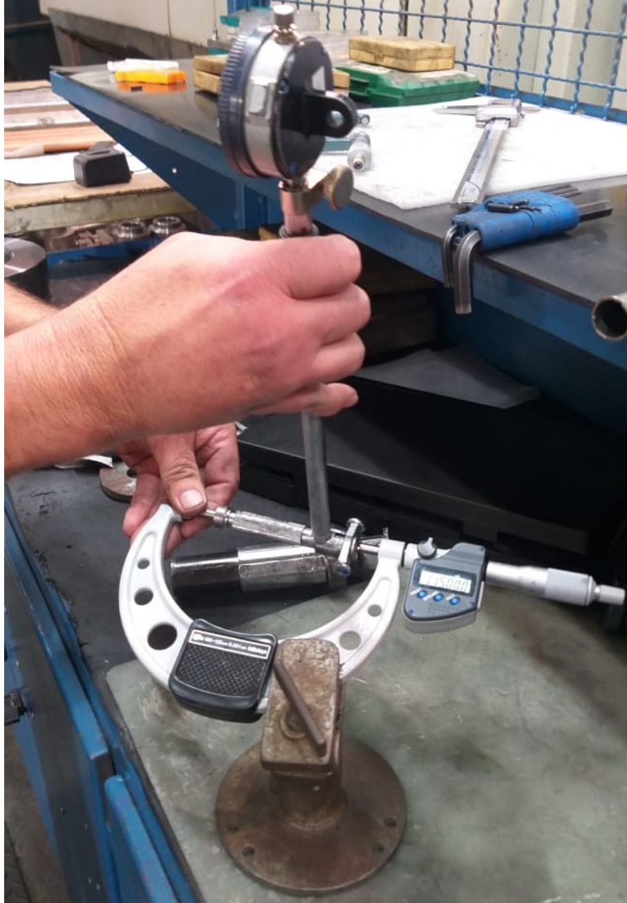
Figura 32 – Regulagem do comparador de diâmetros internos com o micrômetro
