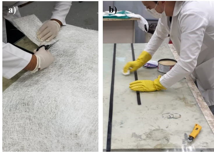
Figura 9 – Produção do Laminado: Corte da fibra (a) e Limpeza da chapa de vidro (b).
