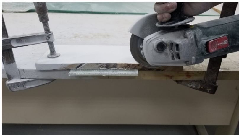
Figura 13 – Preparação dos Corpos de Prova para determinação das propriedades mecânicas.
