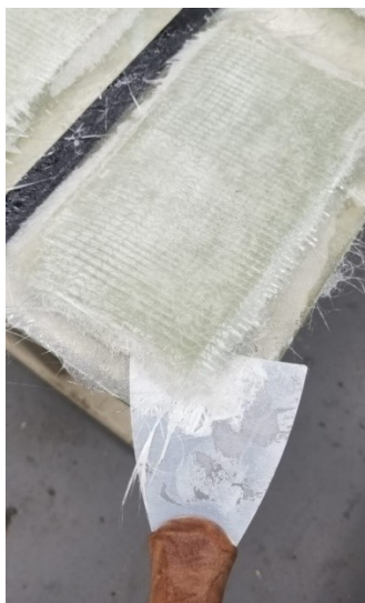
Figura 12 – Desmolde de uma das placas laminadas produzidas.
