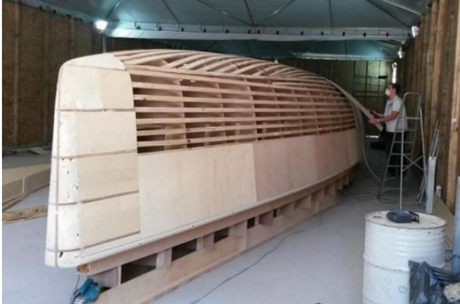
Figura 3 - Fabricação de plug em madeira.
