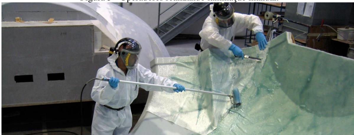
Figura 5 - Operadores realizando laminação manual.
