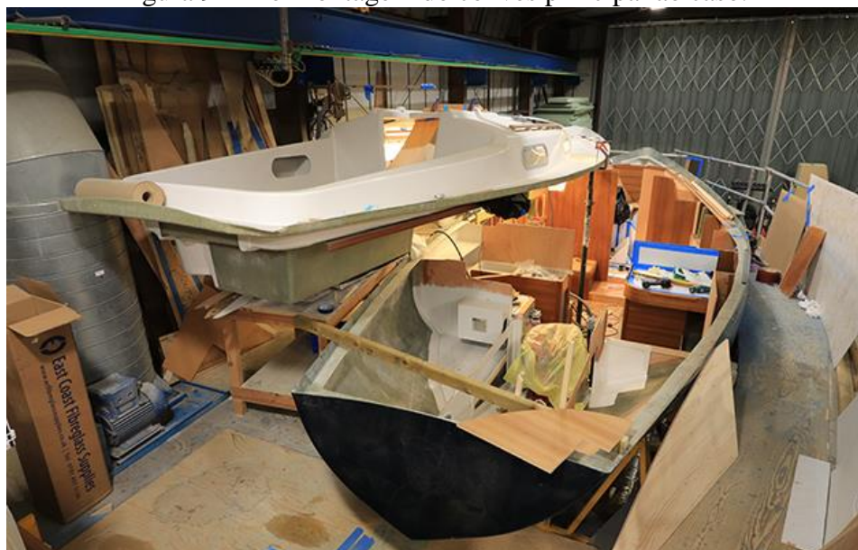
Figura 9 – Pré-montagem do convés principal ao caso.
