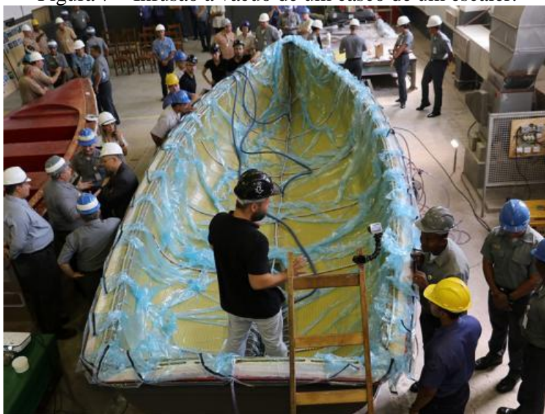
Figura 7 – Infusão a vácuo de um casco de um escaler.
