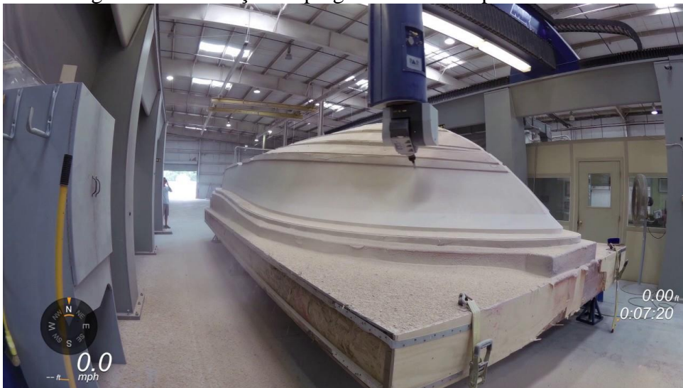
Figura 4 – Fabricação de plug com CNC e espuma sintética.
