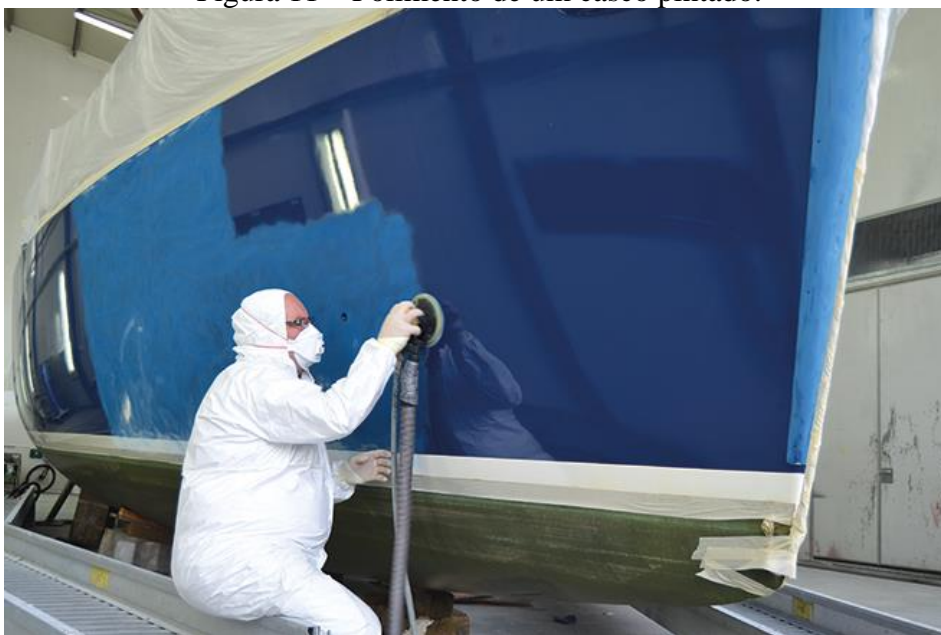
Figura 11 – Polimento de um casco pintado.
