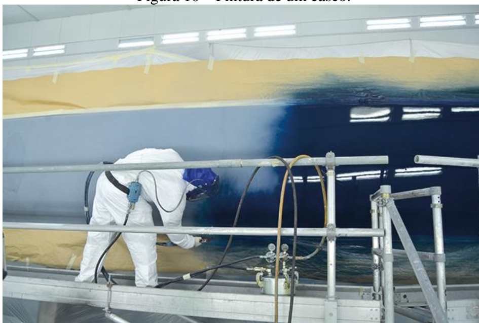
Figura 10 – Pintura de um casco.
