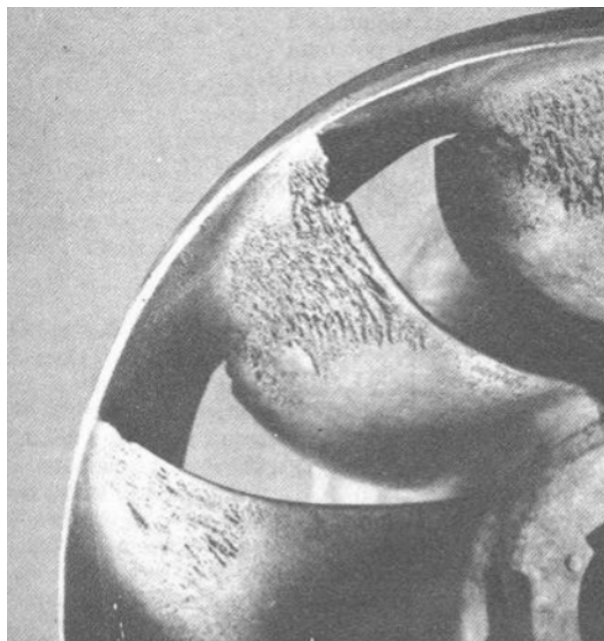
Figura 8 – Pás Francis que sofreram o fenômeno de erosão por cavitação [7].
