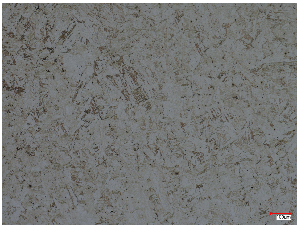
Figura 47 – Microestrutura da amostras ST1, com 951 ppm de enxofre.
