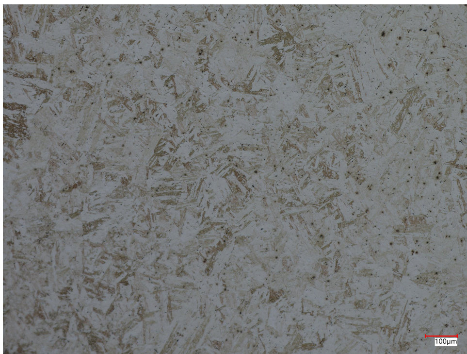
Figura 49 – Microestrutura da amostras ST2, com 396 ppm de enxofre.
