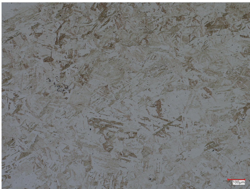
Figura 51 – Microestrutura da amostras ST3, com 67 ppm de enxofre.
