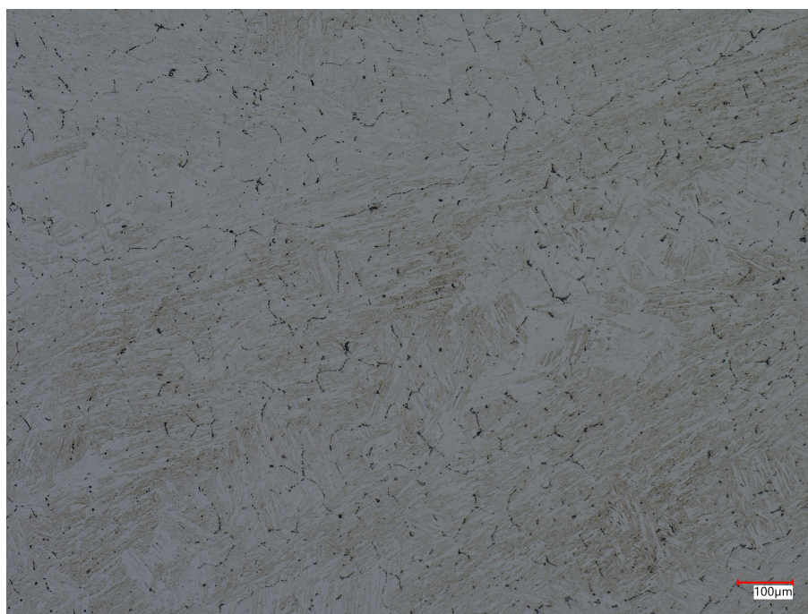
Figura 46 – Microestrutura da amostras SB1, com 951 ppm de enxofre.
