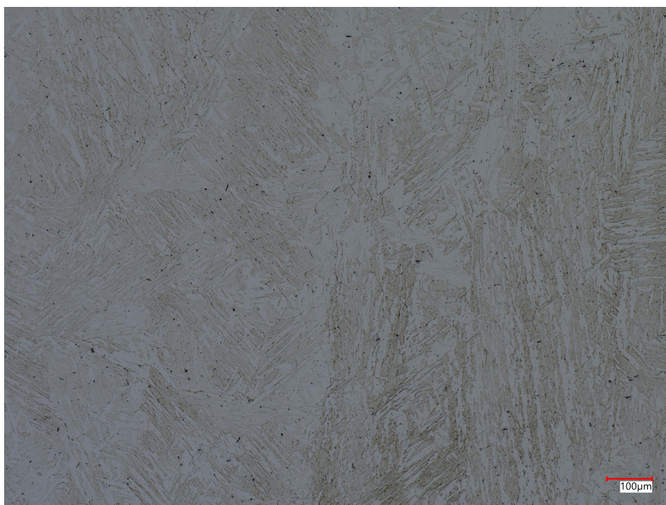
Figura 48 – Microestrutura da amostras SB2, com 396 ppm de enxofre.
