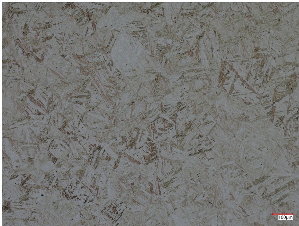
Figura 53 – Microestrutura da amostras ST4, com 20 ppm de enxofre.
