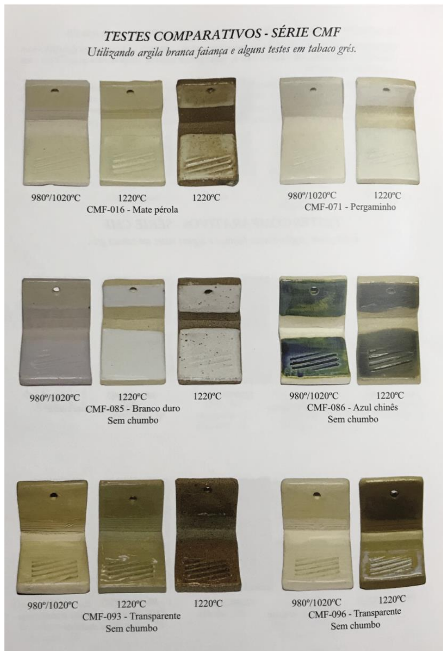
Figura 59: Comparação de tonalidades de esmalte para diferentes temperaturas de queima. Fonte: MUZZILLO, Ocléris. Cerâmica sem segredos . Segunda edição. Artes & Textos, 2018
