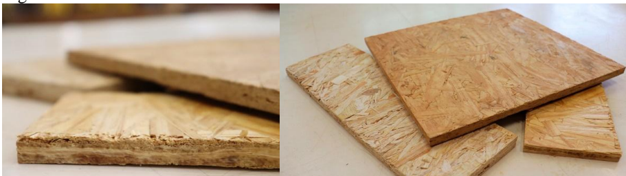
Figura 21- Painel de lascas de madeira
