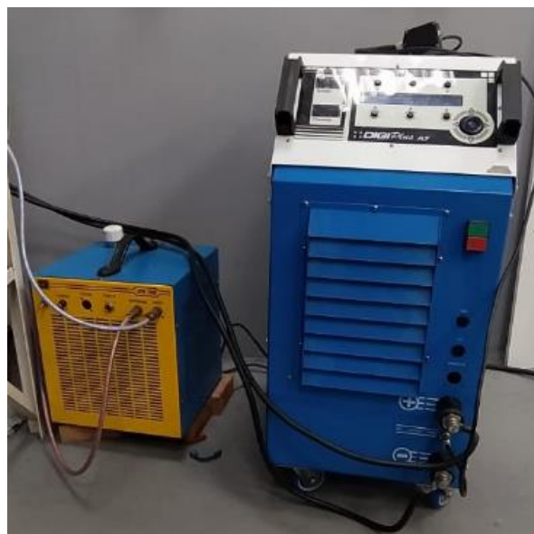
Figura 9 - Fonte de indução e Unidade de Refrigeração
