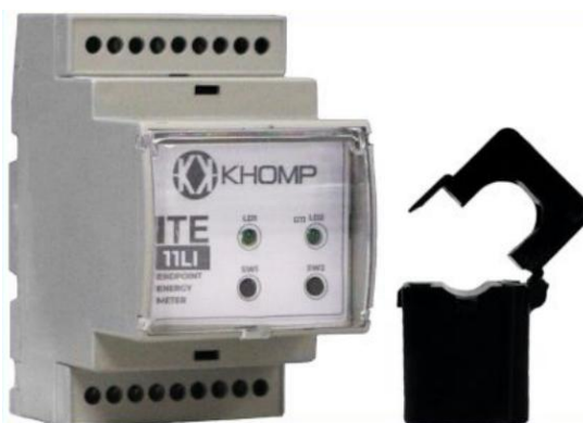
Figura 36 – Medidor de Energia com TC Fonte:(KHOMP, 2020)
