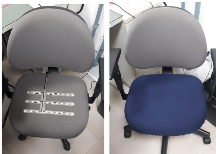
Figura 17 – Sensor de presença instalado na cadeira Fonte: ( Autoral )
