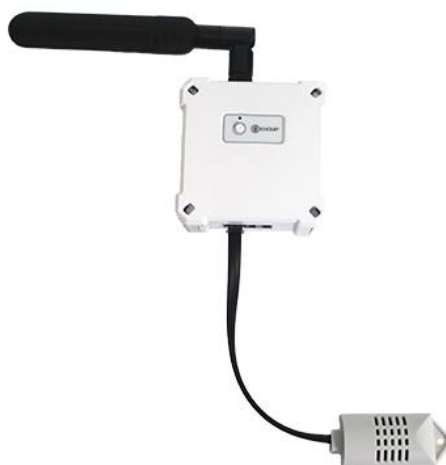
Figura 35 – EM THW 100 acoplada no Endpoint LoRa Fonte:(KHOMP, 2020)
