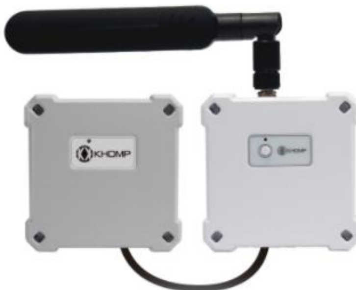
Figura 33 – Extensão IoT EM THW 200 Fonte: (KHOMP, 2020)
