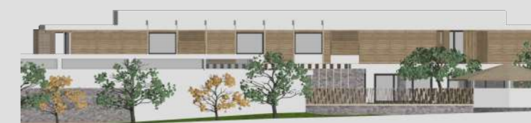
fachada evidenciando os brises articulados e fechamentos vazados
