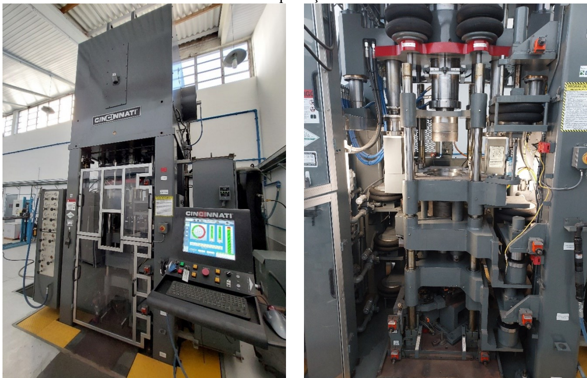
Figura 5 - Prensa mecânica da marca Cincinnati utilizada nesse trabalho e o die set de compactação.
