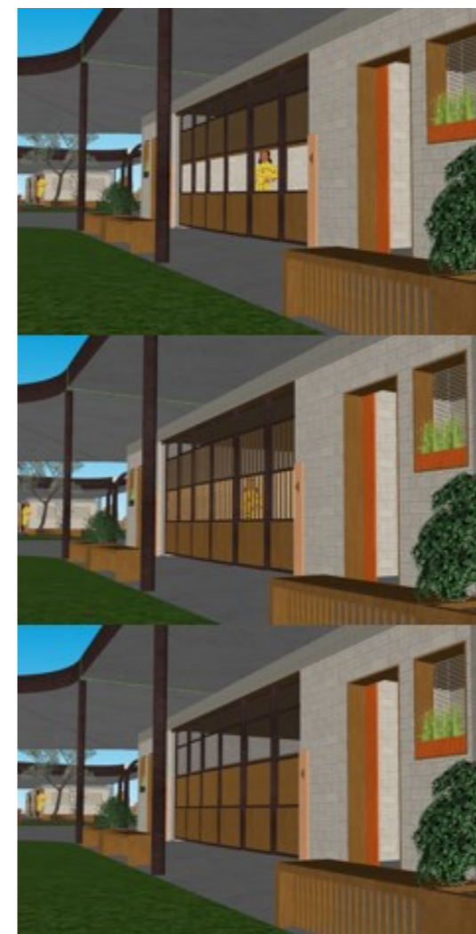
Alteração nos brises das esquadrias
