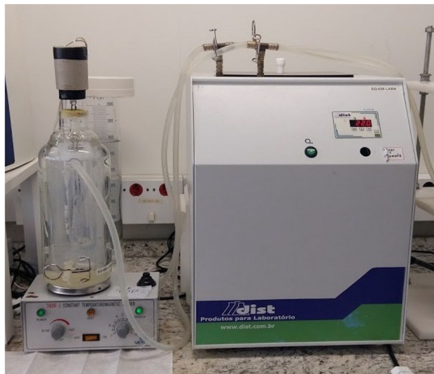
Figura 13: Reator de degradação fotoquímica apoiado sobre agitador magnético, e ao lado do dispositivo de refrigeração.
