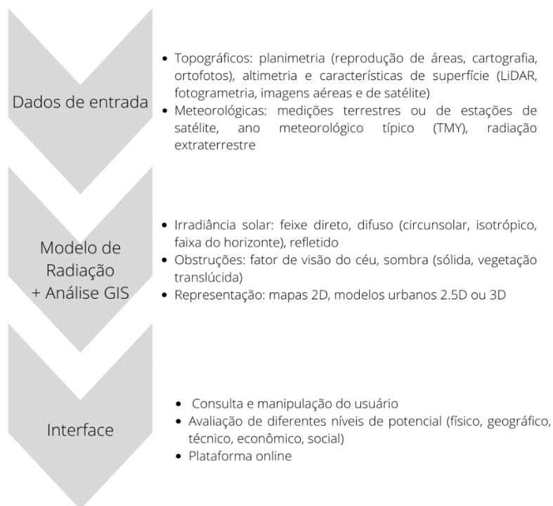
Figura 1 - Etapas e opções envolvidas na avaliação do potencial solar em um determinado local. Fonte: Adaptado de Freitas et al. (2015).
