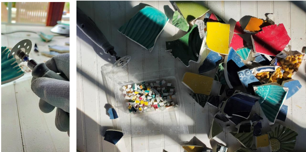
Figura 3 – Etapas do processo aplicado no presente trabalho: à esquerda corte de pequenos cacos para criação de mosaicos, à direita conjunto de pequenos cacos cozidos cortados e cacos cozidos maiores sem processamento de corte.
