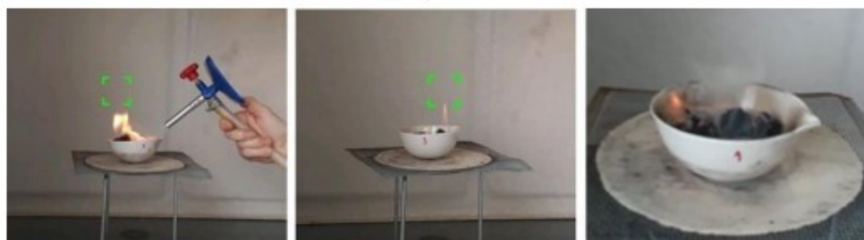
Figura 3: Queima de biocombustíveis sólidos, Amostra 3 confeccionados com biomassa de 100 g de casca de batata inglesa e 70 g borra de café.
