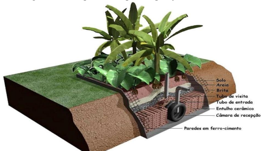
Figura 1 - Tanque de Evapotranspiração e suas camadas.
