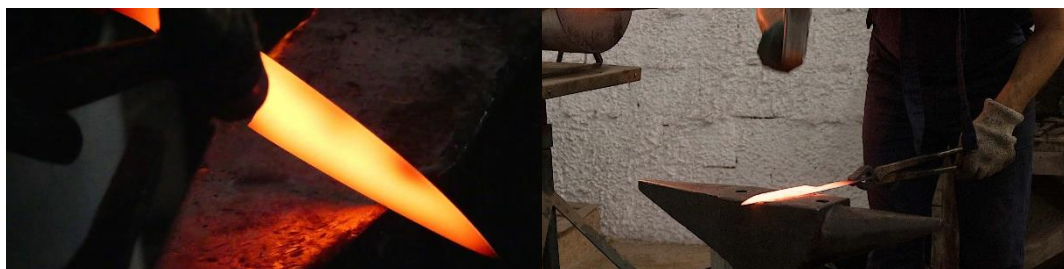
Figura 14 - Aquecimento e moldagem do aço de forma a criar a forma da lâmina.
