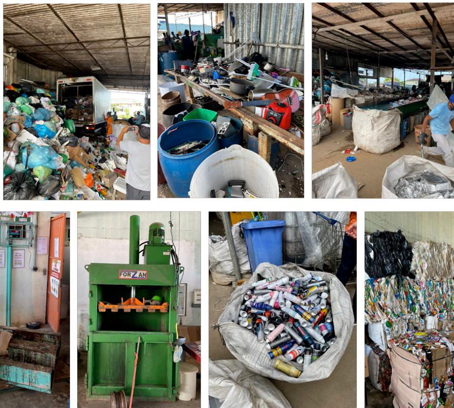
Figura 3: Fotos da cooperativa - recepção dos resíduos, bazar, esteira, balança, prensa e estratégias de acondicionamento de resíduos. Fonte: Elaborado pelos autores.
