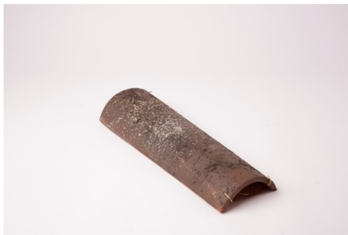
Figura 6 – Telha canudo / campina em Barro Vermelho com acabamento com engobes. Fonte: autores.
