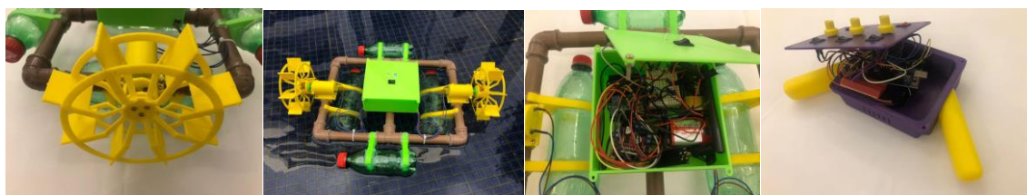
Figura 7: Roda, protótipo, caixa com circuito eletrônico e controle remoto. Fonte: elaborado pelos autores.
