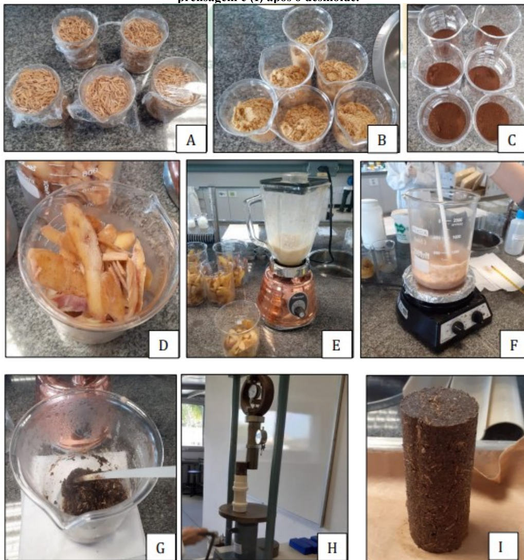
Figura 1: Preparação dos briquetes, sendo (A) casca de arroz, (B) casca de laranja, (C) borra de café, (D) casca de batata, (E) moagem da casca de batata, (F) aquecimento e mistura, (G) mistura final, (H) prensagem e (I) após o desmolde.
