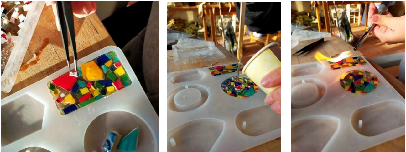
Figura 4 – Etapas do processo dos mosaicos produzidos com resina com cacos vidrados, à esquerda colocação de fragmentos; ao centro verter da resina epóxi sobre os cacos colocados na cavidade moldante; à direita aquecimento com maçarico do material para eliminação de bolhas residuais.
