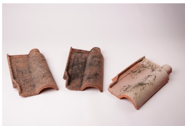
Figura 7 – Telhas com diferentes acabamentos superficiais obtidos a partir de técnicas simples de pulverização nas superfícies cerâmicas com diferentes suspensões argilosas (Torreense). Fonte: autores.
