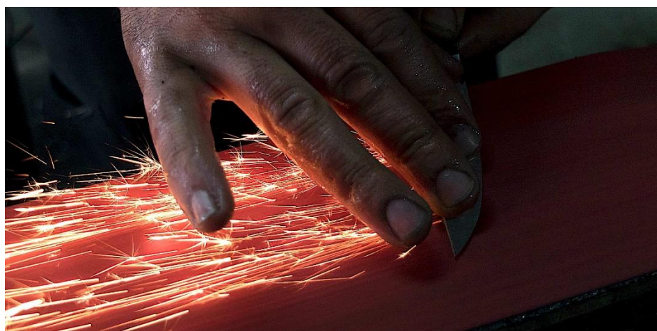
Figura 15. Afição da lâmina usando uma lixa de metal.
