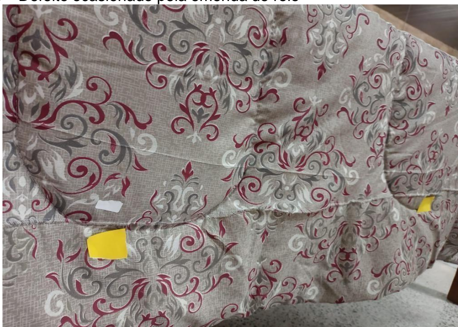
Figura 17 - Defeito ocasionado pela emenda de rolo
