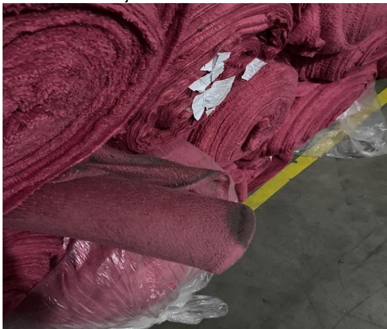
Figura 9 - Rolo I identificado com sujeira
