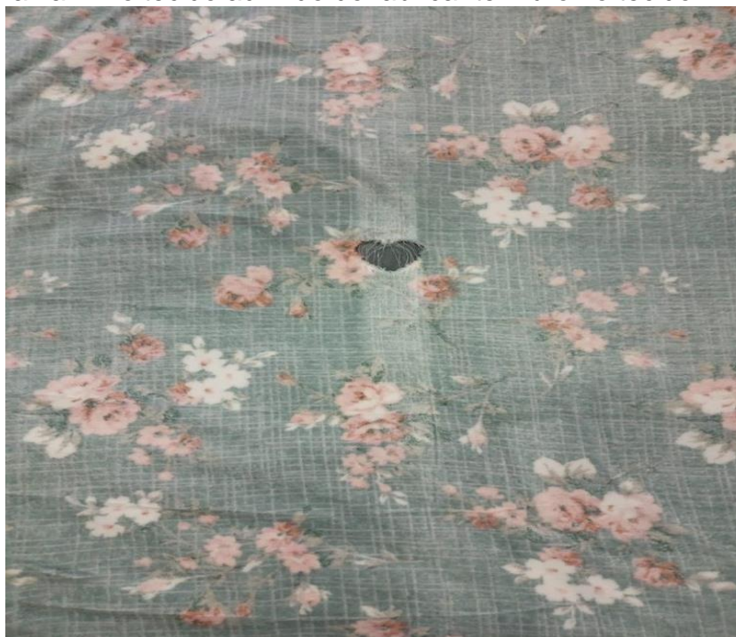
Figura 15 - Falha III no tecido advindo do fabricante - furo no tecido
