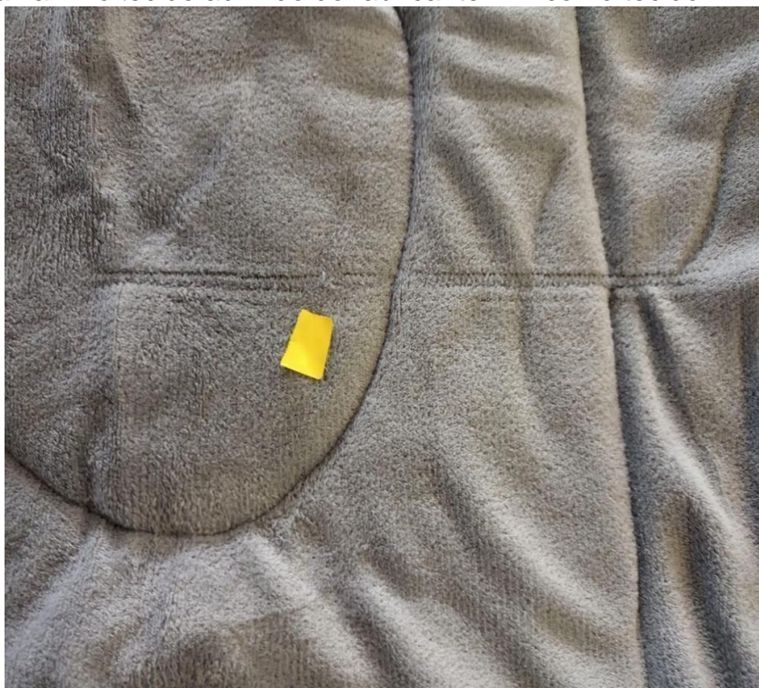
Figura 14 - Falha II no tecido advindo do fabricante - vinco no tecido
