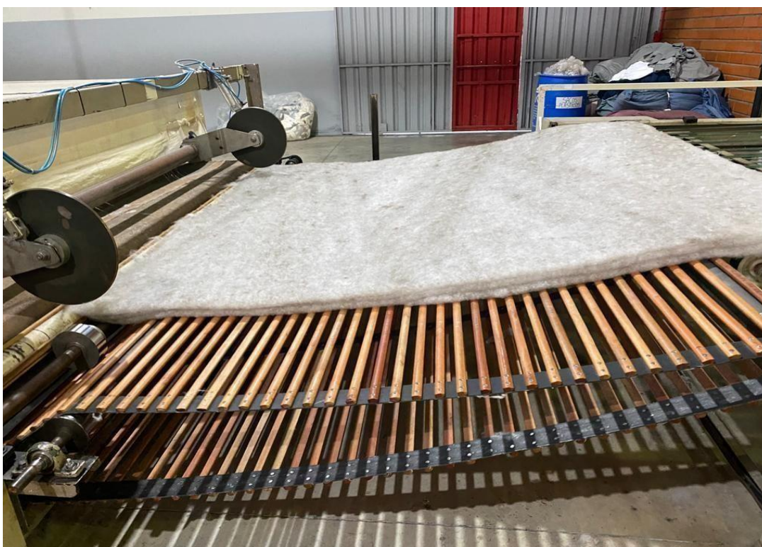
Figura 18 - Produção da manta de enchimento do edredom microfibra/plush
