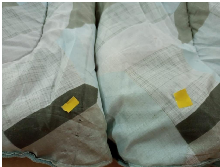
Figura 13 - Falha I no tecido advindo do fabricante - vinco no tecido
