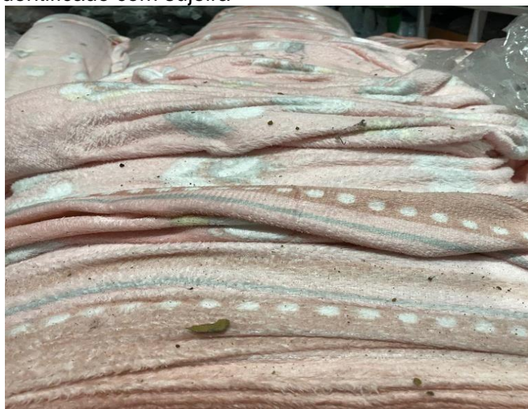
Figura 10 - Rolo II identificado com sujeira
