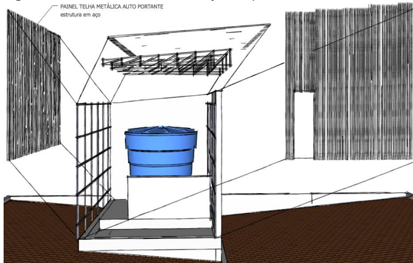
Figura 44 - Reservatório com remoção de painéis.
