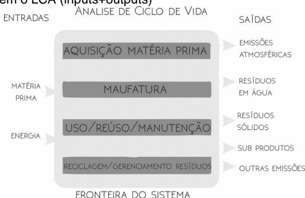
Figura 14: Modelação do sistema e obtenção dos dados que constituem o LCA (inputs+outputs)
