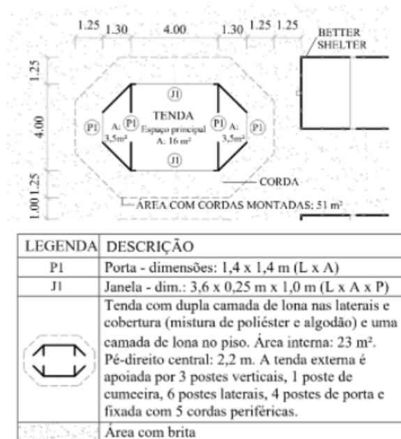
Figura X: Dimensões da tenda da UNHCR Fonte: Carbonari (2018)
