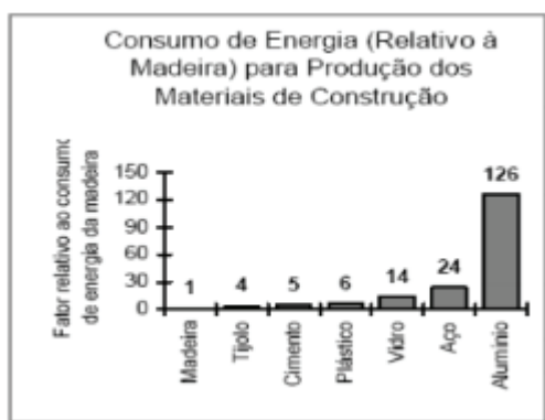
Figura 10: Consumo de Energia para a Produção de Materiais de Construção. Fonte: (DEMARZO et al., 2017)
