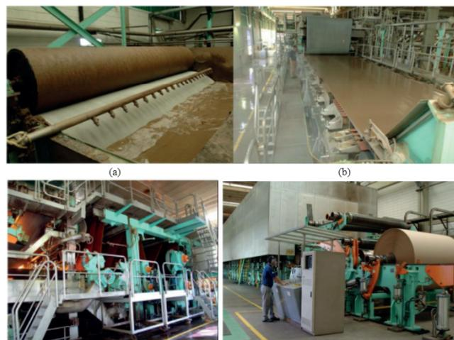
Figura 17 - (a) Preparo da massa, (b) Formação da folha de papel, (c) Prensagem, (d), Acabamento e rebobinamento. Fonte: Aníbal (2015).
