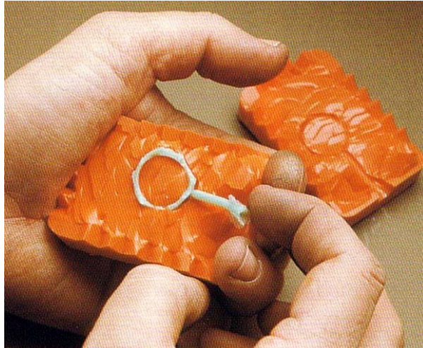
Figura 5 – Molde de borracha Fonte: www.ibgm.com.br
