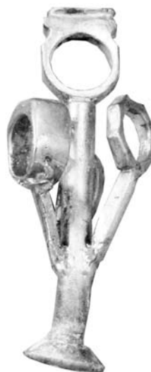
Figura 6 – Árvore de alumínio Fonte: www.ibgm.com.br
