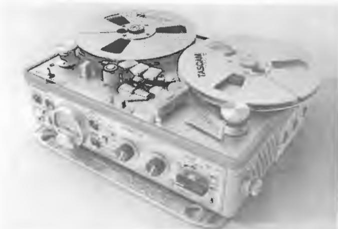
**Figura 14: Gravador de fita de 1/4 polegada NAGRA modelo IV-S.**
