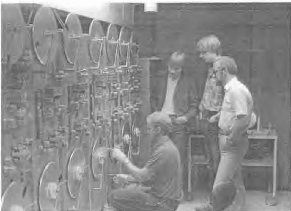
**Figura 18: Dummy Recorders - Gravadores de magnético perfurado usados para reproduzir e gravar o som durante a mixagem.** <http://www.filmsoundsweden.se/backspegel/harrison.html>
