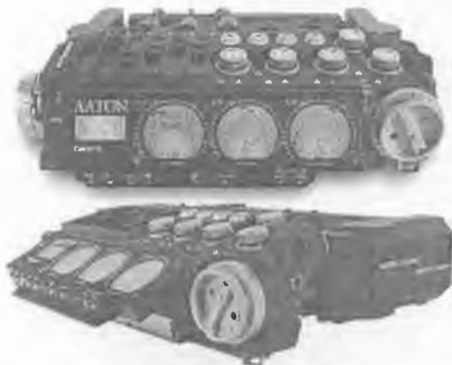
**Figura 16: Gravador digital de disco rígido Aaton modelo Cantar X**
